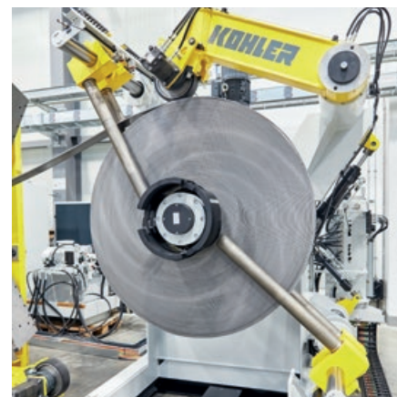
Coilladestuhl und Haspel können mit einer Tragkraft bis zu 35t geliefert werden
