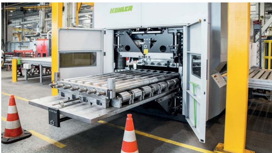
Mit dem erweiterten Reinigungssystem des Peak Performer können die Richtwalzen und Stützrollen zur einfachen und schnellen Reinigung vollständig und elektromotorisch aus der Maschine gefahren werden.
