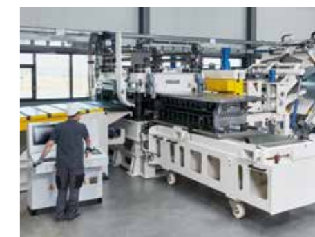
— Die Richtwalzen-Wechselkassette erweitert das Spektrum der bearbeitbaren Banddicken
