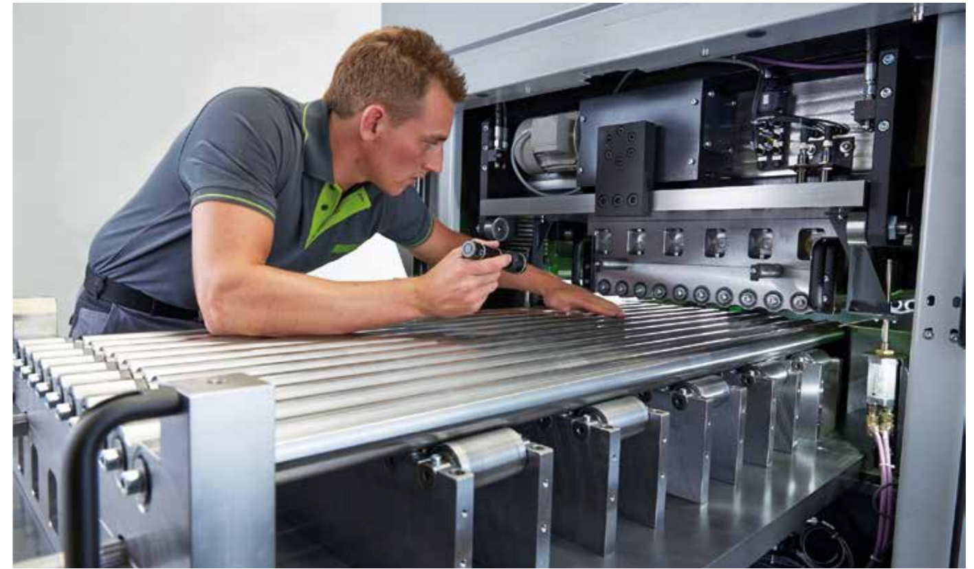
— Einfache Reinigung und Inspektion dank elektromotorischer Reinigungs- und Schnellwechseleinrichtung
