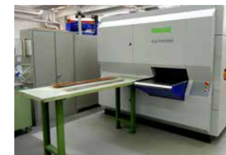
— Die kompakte und sauber eingehauste Teilerichtmaschine Peak Performer 50P.600 von der Auslaufseite gesehen. Die gerichteten Edelmetallstreifen werden auf dem Tisch abgelegt.
