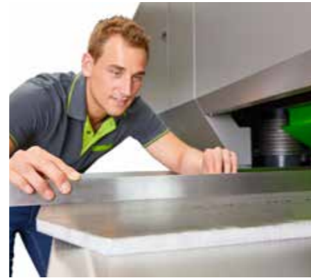
— Mit der Teilerichtmaschine Peak Performer lassen sich auch dicke Bleche hochpräzise richten
