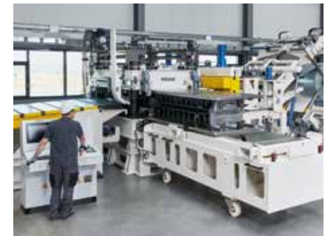
— Die Richtwalzen-Wechselkassette erweitert das Spektrum der bearbeitbaren Banddicken
