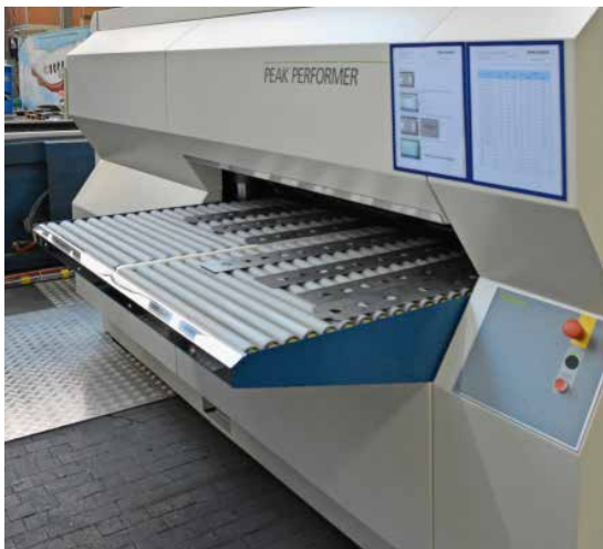
Für das Richten der noch nassen Zuschnitte bleibt nach dem Abschrecken nur ein kurzes Zeitfenster.
