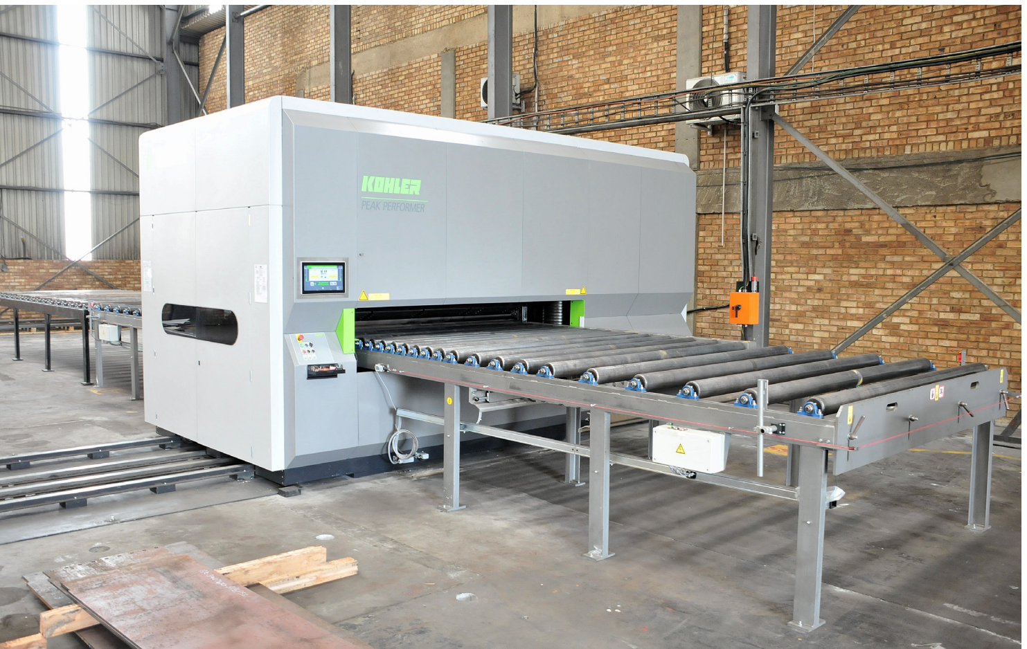
Die KOHLER Peak Performer 130P.2500 bei TW Profile Services ist die erste Teilerichtmaschine ihrer Art in Südafrika.
