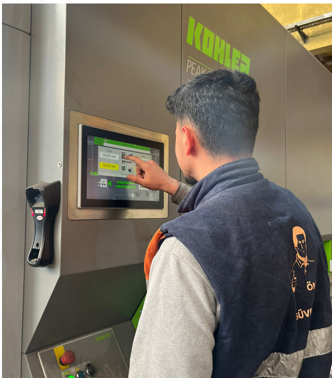
Önder richtet mit der KOHLER Peak Performer monatlich rund 150 Tonnen Stahl mit Dicken bis zu 25 Millimeter.
