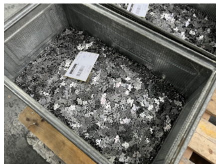
DREEFS produziert gestanzte und geschweißte Teile mit Geschwindigkeiten von 150 bis 6.400 Teilen pro Minute. Der Großteil der Produkte wird als Einzelteile in Kisten gestanzt
