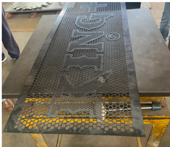
Auf der 30P.1300 können auch perforierte Bauteile wie Lautsprecherabdeckungen oder Loch- und Fassadenbauteile optimal gerichtet werden.
