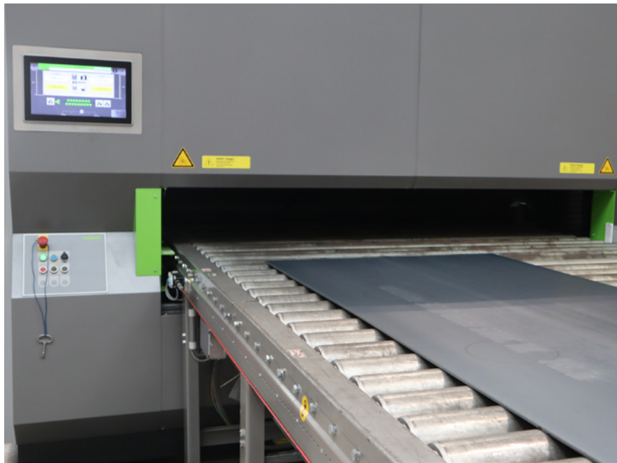
Die geforderte Präzision beim Richten beträgt 0,5 mm auf 1m, was bedeutet, dass die Teile aus Stahl S700, die auf einer perfekt geschliffenen Steinplatte liegen, nur 0,5 mm von dieser Platte abstehen dürfen.
