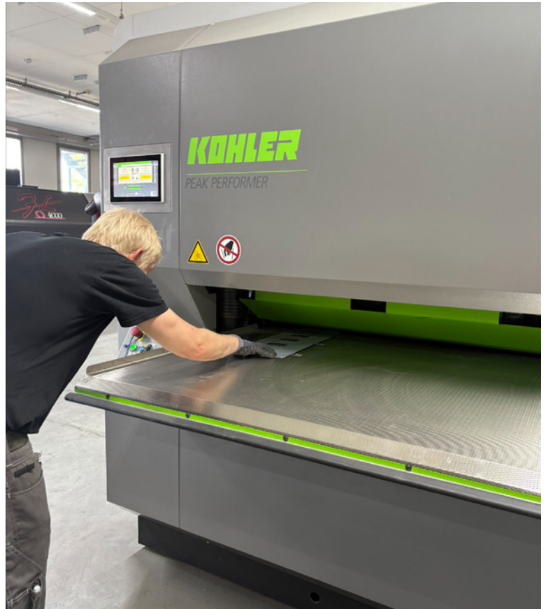
Ob Teile aus Stahl oder Aluminium, durch das professionelle Richten werden nachgelagerte Arbeiten prozesssicher und effizienter. Bild: ALCOLOR
