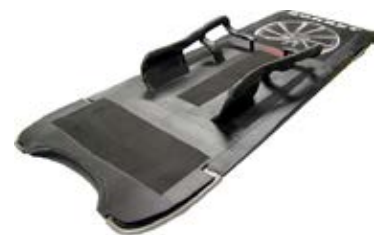
Gefertigt werden die Skeleton-Schlitten aus nichtrostenden und hochfesten Stählen mit drei bis acht Millimetern Stärke. Sie bestehen aus einer Verkleidung, einem Rahmen und zwei Kufen. Bild: Institut für Forschung und Entwicklung von Sportgeräten (FES)
