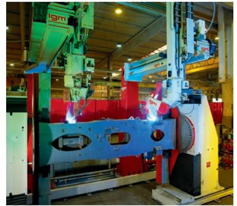
Einer der Fertigungsprozesse nach dem Richten ist das automatische Roboter-Schweißen. Gerichtete Teile sorgen für einen konstanten Schweißspalt, und Vorrichtungen können vereinfacht werden, da gerichtetes Material beim Schweißen nur in geringem Umfang Spannungen freigt. Bild: Liebherr-Hydraulikbagger GmbH
