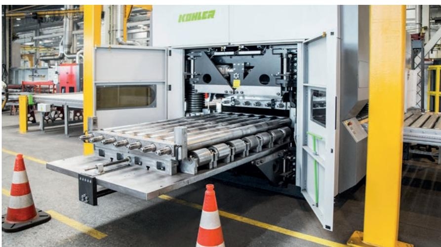
Mit dem erweiterten Reinigungssystem des Peak Performer können die Richtwalzen und Stützrollen zur einfachen und schnellen Reinigung vollständig und elektromotorisch aus der Maschine gefahren werden.
