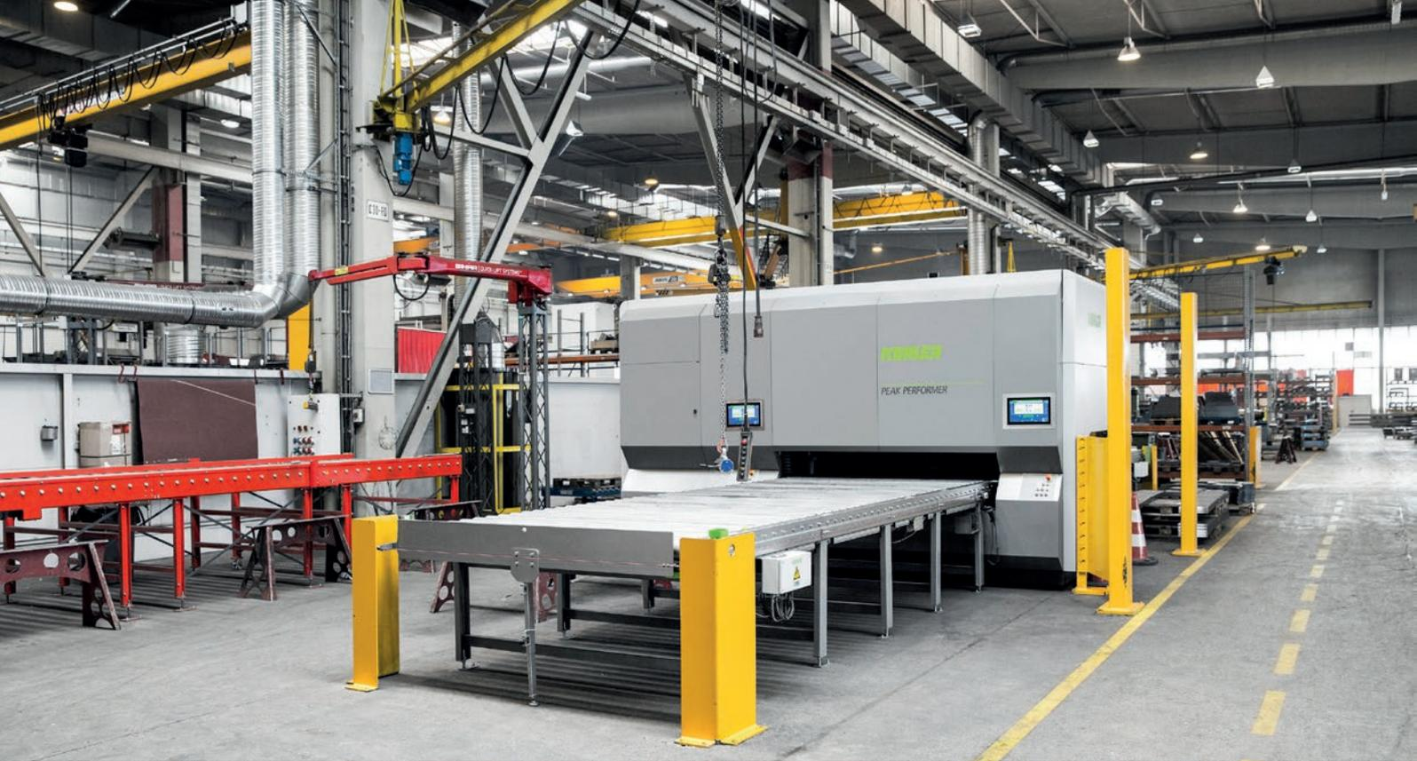
Die Liebherr-Hydraulikbagger GmbH setzt im Stahlbau auf die Präzision und Wirtschaftlichkeit der Peak Performer Teilerichtmaschine von KOHLER.
