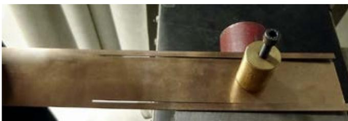
Bild oben: Das ungerichtete Material weist Spannungen und Unebenheiten auf. Bild unten: Bei präzisionsgerichtetem Bandmaterial werden die Spannungen auf ein Minimum reduziert.
