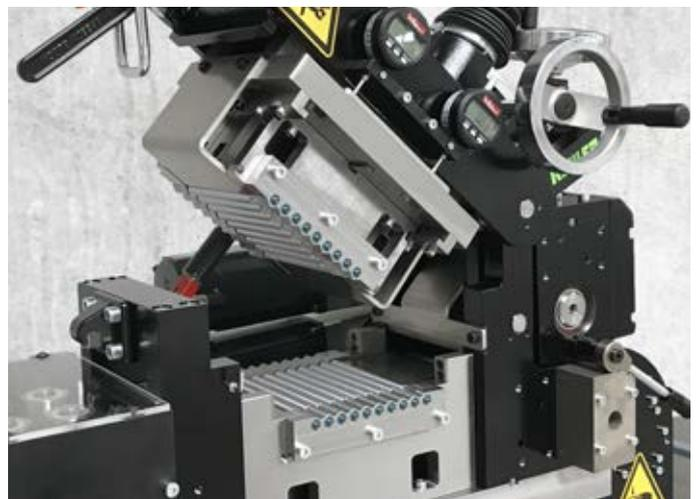
Dank leichter Zugänglichkeit kann das Reinigen der Stützrollen und Richtwalzen schnell und einfach durchgeführt werden.
