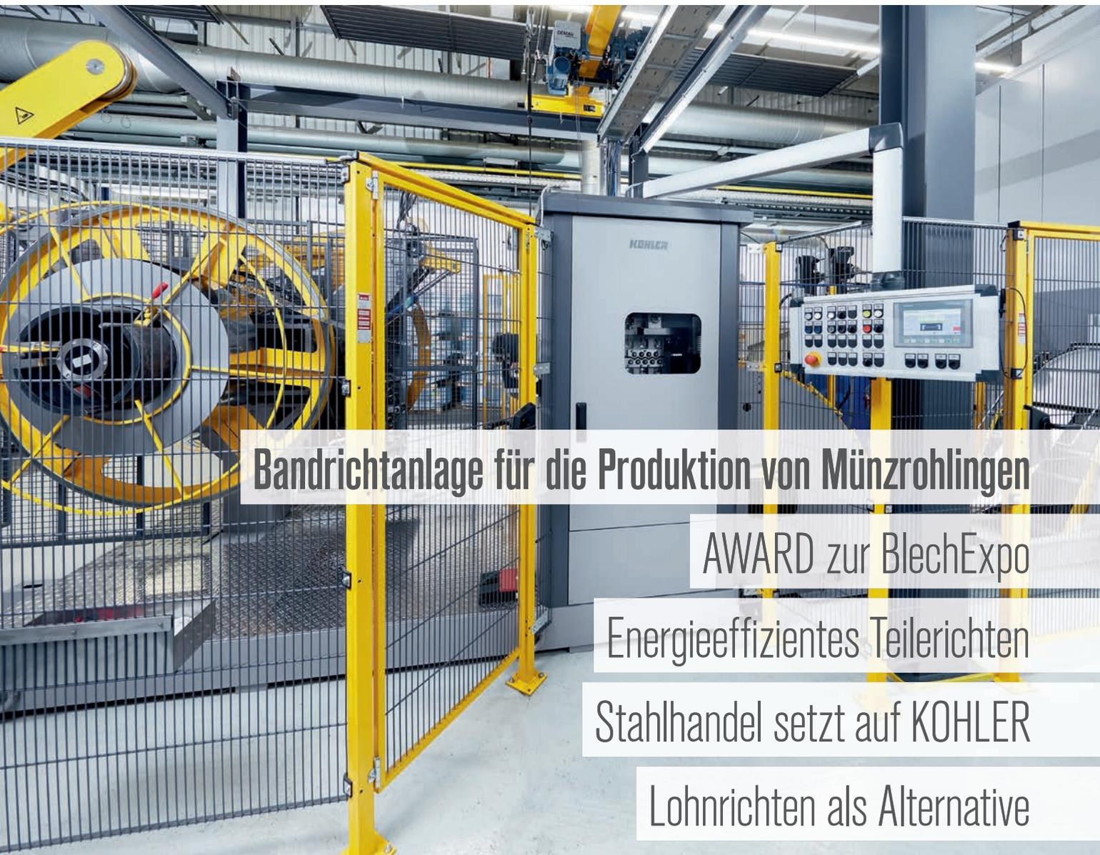
**Bandrichtanlage für die Produktion von Münzrohlingen**
