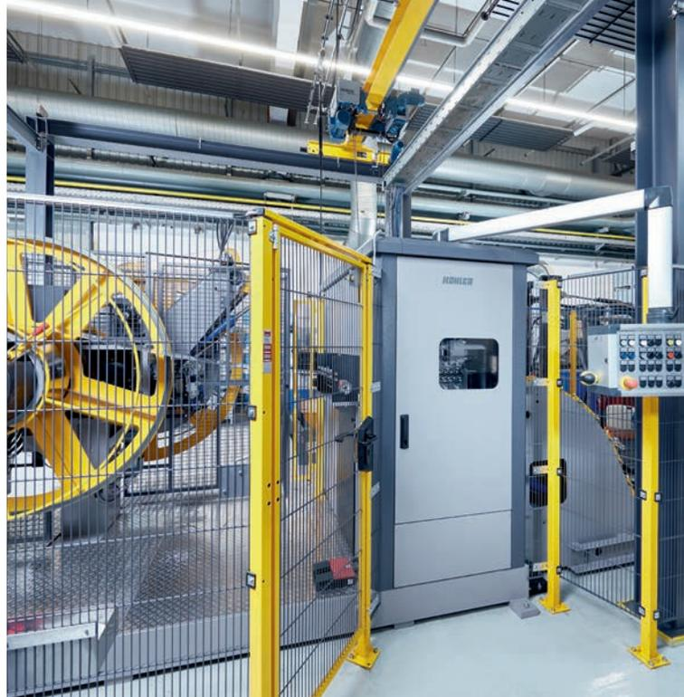
Die von der Freiburger EuroMetall produzierten Münzrohlinge werden durch Stanzen und Randstauchen erzeugt. Die Vorarbeiten werden von einer KOHLER Bandanlage mit (v.l.n.r.) Doppelabwickelhaspel, Bandrichtmaschine und Bandübergabe an eine Schnellstanze geleistet.
