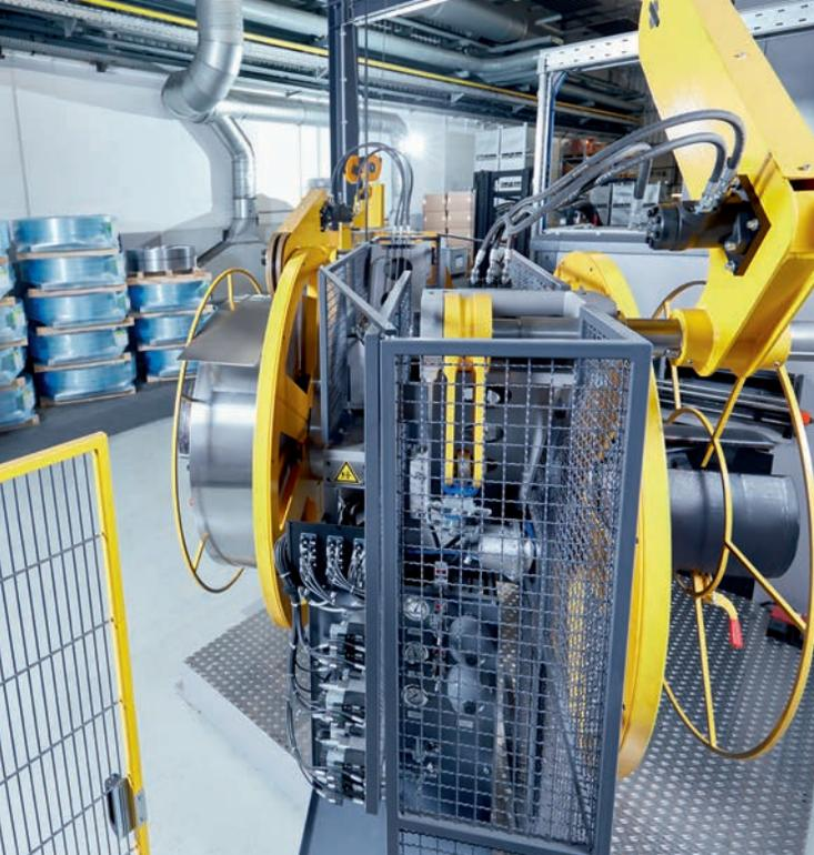
KOHLER Doppelabwickelhaspel, Typ 5000.2 H, zur Aufnahme von zwei Coils, je bis 5,000 kg Gewicht, Bandbreiten bis 500 mm und Banddicken bis 3 mm. Die Coils werden mithilfe eines hydraulischen Schiebekeilsystems mit Nachspannautomatik auf den Dornen fixiert.
