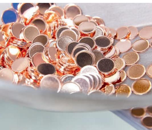
Bild ganz oben: Münzrohlinge und übriggebliebenes Stanzgitter. Die Freiburger EuroMetall GmbH fertigt Rohlinge in millionenfacher Stückzahl in unterschiedlichen Größen aus einer großen Bandbreite von Werkstoffen und mit immer gleichbleibender Präzision.
