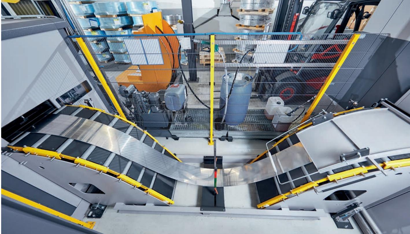
Bandübergabe an die nachfolgende Schnellstanze. Die Bandschleife zwischen Bandrichtmaschine und der Stanzanlage ist als Bandübergabetisch ausgelegt. Sie stellt eine flexible und gleichmäßige Bandversorgung der Stanzanlage sicher.
