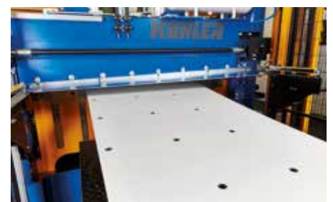
— Die Querteilschere längt das Band auf die exakte Länge des späteren Kantprofils ab.
