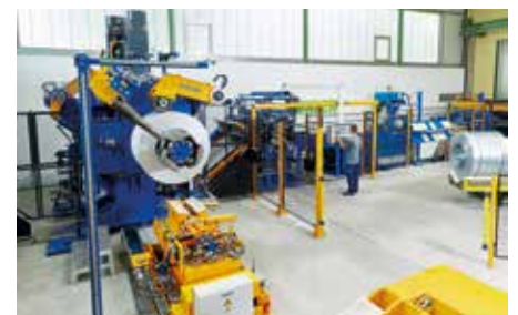
— Die gesamte Fertigungslinie im Überblick (v. l.) mit Coilbereitstellung, Ladewagen, Wendehassel, Richtmaschine, Schlaufengrube, Lochstanze und Querteilanlage.
