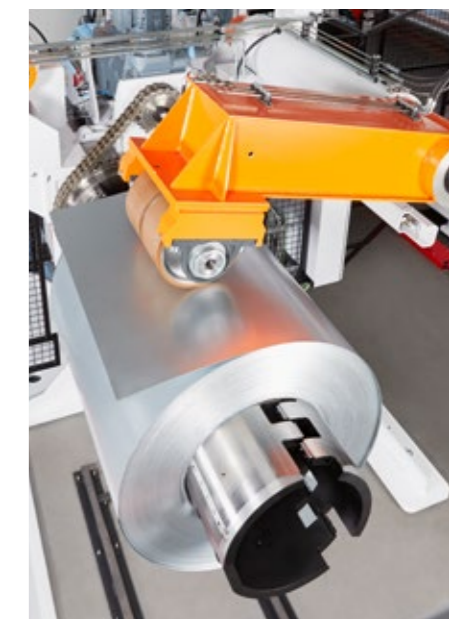
— Doppel-Abwickelhaspel mit zwei Spreizbereichen ohne Zusatzschale
