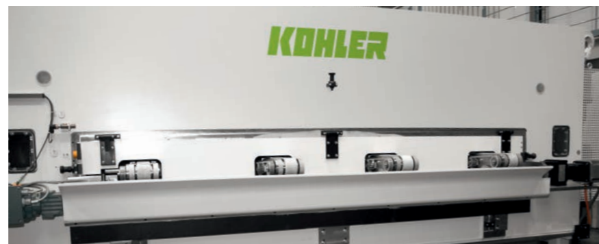
— Auslaufseite einer Waschmaschine
