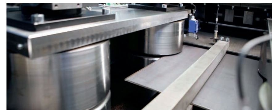
— Hochkantrichtapparat für Dickbleche
