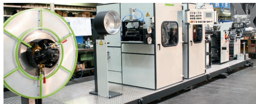
— Umspulanlage mit Hochkantrichttechnik
