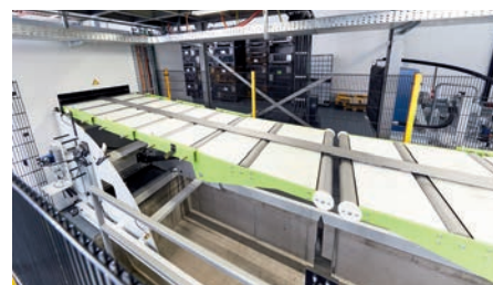
Die Bandübergabe an die folgende Presse oder Stanze erfolgt über eine Schlaufengrube mit einem Radius von 2.000 mm. Bei Bedarf kann die Bandübergabe horizontal über einen Bandübergabetisch erfolgen.
